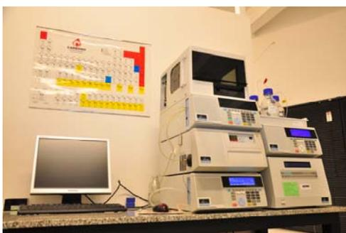
Cromatógrafo Líquido Perkin Elmer con detector UV y Fluorescencia (PAH, método EPA SW 8310)
