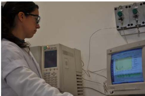
Cromatógrafo Gaseoso destinado al análisis de Hidrocarburos Totales de Petróleo, método SW EPA 8015 principalmente
